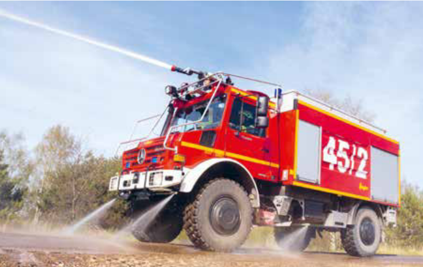
Brandbekämpfung im Pump-&-Roll-Verfahren
